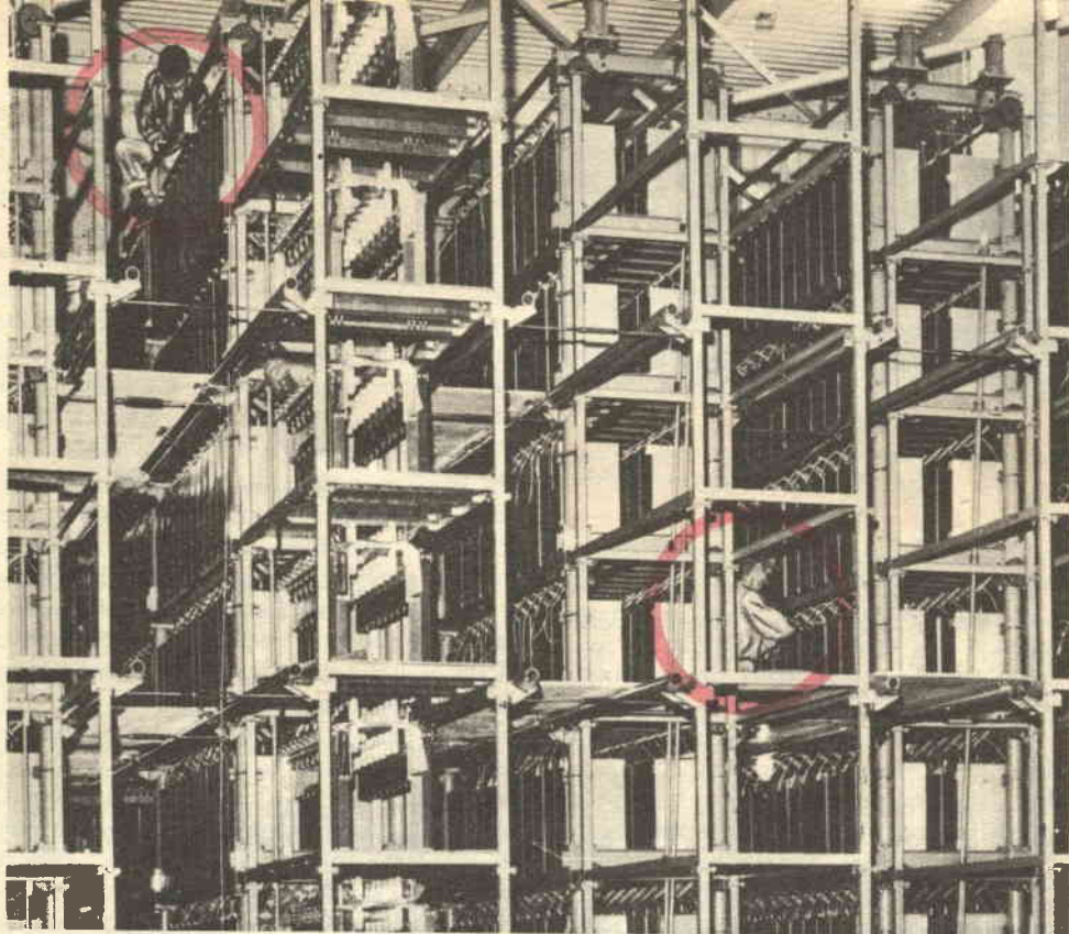
Il gigantesco banco di condensatori di Los Alamos (Nuovo Messico) produce una scarica di 40 milioni di ampere in 10 microsecondi. Gli operai, racchiusi nei cerchi, danno un'idea delle dimensioni complessive dell'apparecchio, del quale nella fotografia è rappresentata solo una terza parte.
