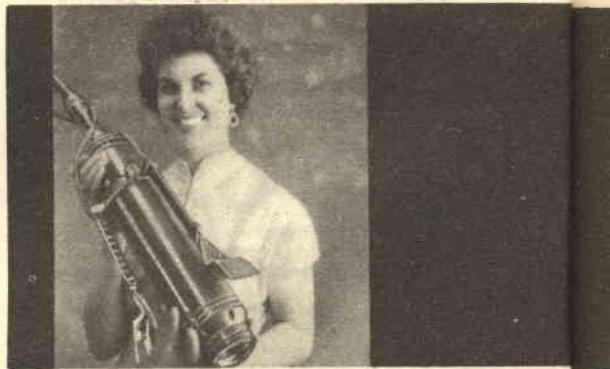
Questa camera televisiva che viene costruita per uso privato teletrasmette immagini dal fondo dei pozzi.
